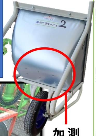
測定器運搬用一輪車には水抜き穴加工をしております。
